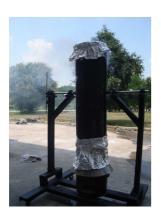
ออกแบบ ผลิตเตาอบปิ้งไก่แบบไก่เป็นตัวสามตัวในแนวตั้ง (ดังรูป) โดยมีลักษณะเป็นท่อทรงกระบอกในแนวตั้งที่เสียบไก่สามตัวไว้กับแกน มีจาน รองน้ำมันไก่ไม่ให้หยดลงไปบนเตา ซึ่งเตาที่ใช้เป็นเตาอั้งโล่ธรรมดาใน ท้องตลาด ท่ออบมีกลไกที่สามารถพลิกกลับเอาด้านบนกลับมาลงข้างล่างได้
