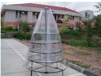
ออกแบบ สร้างอุปกรณ์ และทดลองอบแห้ง ลักษณะของเครื่องอบเป็นกระโจม (คล้ายกระโจมอินเดียนแดง) หุ้มด้วยพลาสติกใส ที่มีชั้นอบแห้งวางซ้อนกันในแนวตั้งสี่ชั้น (ตั้งรูป) ซึ่งนอกจากจะทำให้อบแห้งได้อย่างรวดเร็วแล้ว ยังประหยัดพื้นที่ และกันฝน กันฝุ่น กันแมลงอีกด้วย การอบได้รวดเร็วเกิดจากความร้อนภายในที่มีค่าประมาณ 55 องศาเซลเซียส และกระแสอากาศร้อนที่ลอยตัวสูงขึ้นด้วยการช่วยเหลือของกระโจมทรงสูง จึงช่วยดูดซับเอา
